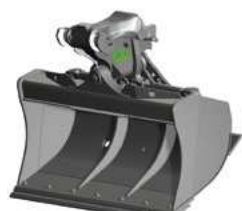
LAME LISSE AVEC CONTRE-LAME BOULONNÉE RÉVERSIBLE (CLBR) + LAME ARRIÈRE (LAR) Épaisseur 25 mm
