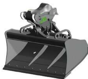
LAME LISSE AVEC CONTRE-LAME BOULONNÉE RÉVERSIBLE (CLBR) Épaisseur 20 mm
