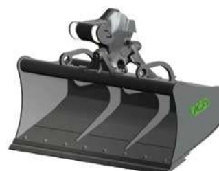
LAME LISSE AVEC CONTRE-LAME BOULONNÉE RÉVERSIBLE (CLBR)
